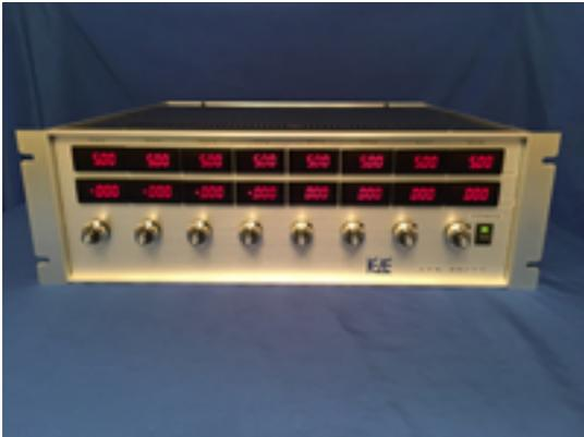
SAシリーズ高圧電源ユニットは8出力の高圧電源ユニットです。電気泳動、電気集塵XY偏向電源、静電電極電源等1度に数多くの高電圧が必要な場合にたいへん重宝です。19インチ用ケースに収納されております。
