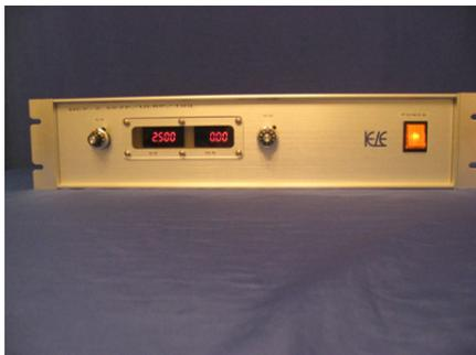
MCPシリーズ高圧電源ユニットは超低リップル仕様のMCP用高圧電源ユニットです。外部入力をアースに接続すると通常のMCP電源として外部高圧電源（MAX±10kV）を接続すると重畳電源として使用できます。
