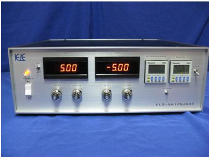
ESCTシリーズ静電チャック用高圧電源ユニットです。1CHのタイマー制御機能付きの双極静電チャックに最適です。内部に高圧リレーを搭載しON/OFF ディスチャージ、反転出力機能を搭載しております。
