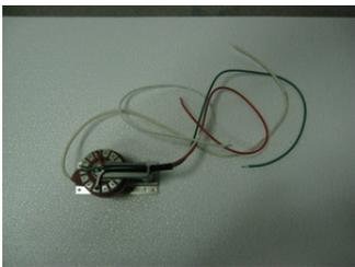
この高周波高電圧トランスは周波数 20 kHz ± 10 kV (波高値) 10 mA の大気圧プラズマ実験用の量産型高周波トランスです。入力波形を 100 倍に増幅致します。最大出力 ± 100 V → ± 10 kV です。
